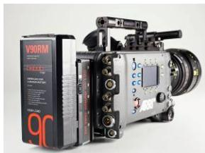
Der Hot Swap Adapter ML-120 gewährleistet eine unterbrechungsfreie Stromversorgung für ARRI ALEXA, RED ONE, SONY und PANASONIC Kameras. Dank des ML-120 können Akkus im laufenden Kamerabetrieb getauscht werden, ohne dass beim entscheidenden Shoot die Kamera ausfällt. Über ein optisches Signal
