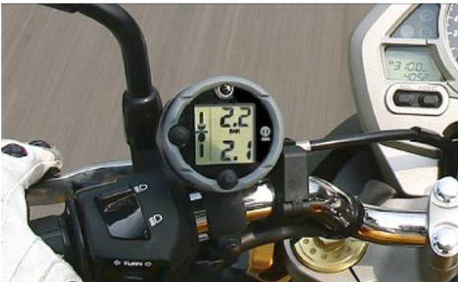
Bei Gefahr warnt zuerst die Displaybeleuchtung und danach die ultrahelle Alarm LED.
