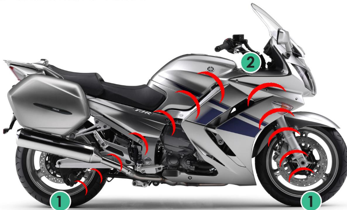
**1= Sensoren 2= Zentraleinheit, Anzeigeelement**
