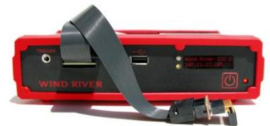
Wind River Workbench On-Chip Debugging läuft auch auf Wind Rivers ICE 2 JTAG Debugger (Bildquelle: Wind River)
