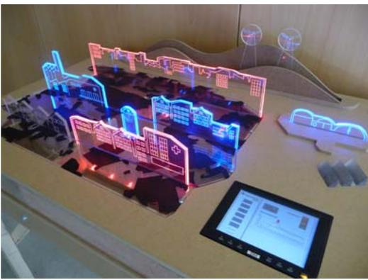
**Bild 3:** Das Modell »Energieeffiziente Stadt« zeigt, wie der Strom- und Wärmebedarf einer Siedlungsstruktur mit Hilfe innovativer Technologien durch erneuerbare Energien gedeckt werden kann.
