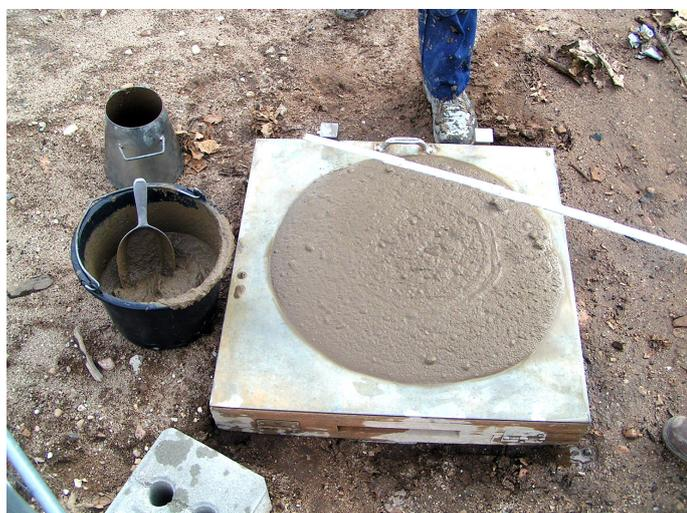
Qualitätssicherung ist ein wichtiger Bestandteil des Verfahrens. Hier wird mittels eines Absetzmaßes die Konsistenz des Flüssigbodens kontrolliert.
