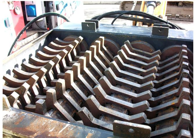
*Verschleißfestes Blech, eine leistungsfähige Hydraulik und synchronisierte Wellen sind die Merkmale des neuen Schaufelseparators SkanCraft Claymaster.*
