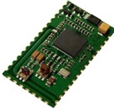
Das UHF Modul ist ein kompaktes Schreib-/Lesemodul, das alle ISO-18000-6 C Tags einschließlich EPC Gen2 unterstützt und auf Basis der UHF Frequenzen 860MHz bzw. 925MHz arbeitet. Somit kann diese UHF Modul nicht nur in Europa sondern auch in den USA eingesetzt werden.
