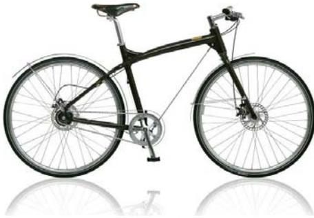
Tretlager und Steuerrohr gespannt ist. Der Rahmen erinnert so an die Takelage des Focksegels der Weltmeerkreuzer. Scheibenbremsen oder die Kombination aus Scheiben- (vorne) und Nabenbremse (hinten)
