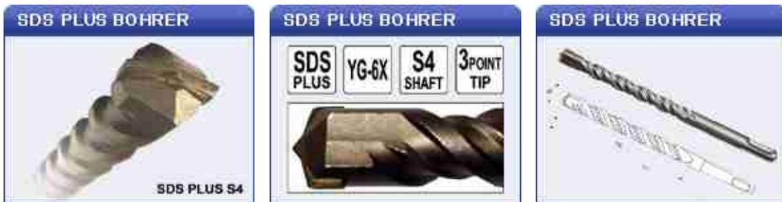
Bei unseren Quattro S4 SDS Plus Bohrern hingegen sind das also vier Plättchen, die unter haltbarer Hartlötung angebracht werden. Der Rest eines Bohrers besteht aus Stahl. Erstens weil Stahl bei weitem günstiger ist und zweitens wird Stahl nicht so schnell spröde wie herkömmliches Hartmetall.
