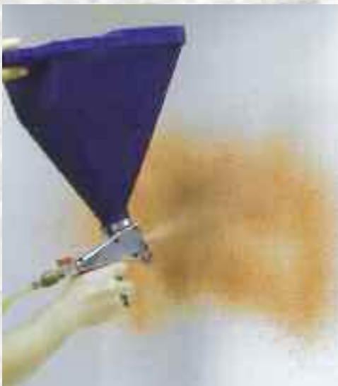
Mit einer Trichterpistole lassen sich kurzfasrige Dekore problemlos spritzen.
