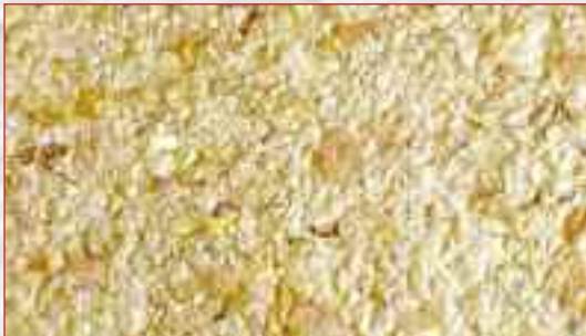
Cosima 13 ..... Naturfasermischung aus Baumwolle, beigen Textilfasern, Pflanzenfasern, Mica-Plättchen, Goldfäden und Kupferfäden
