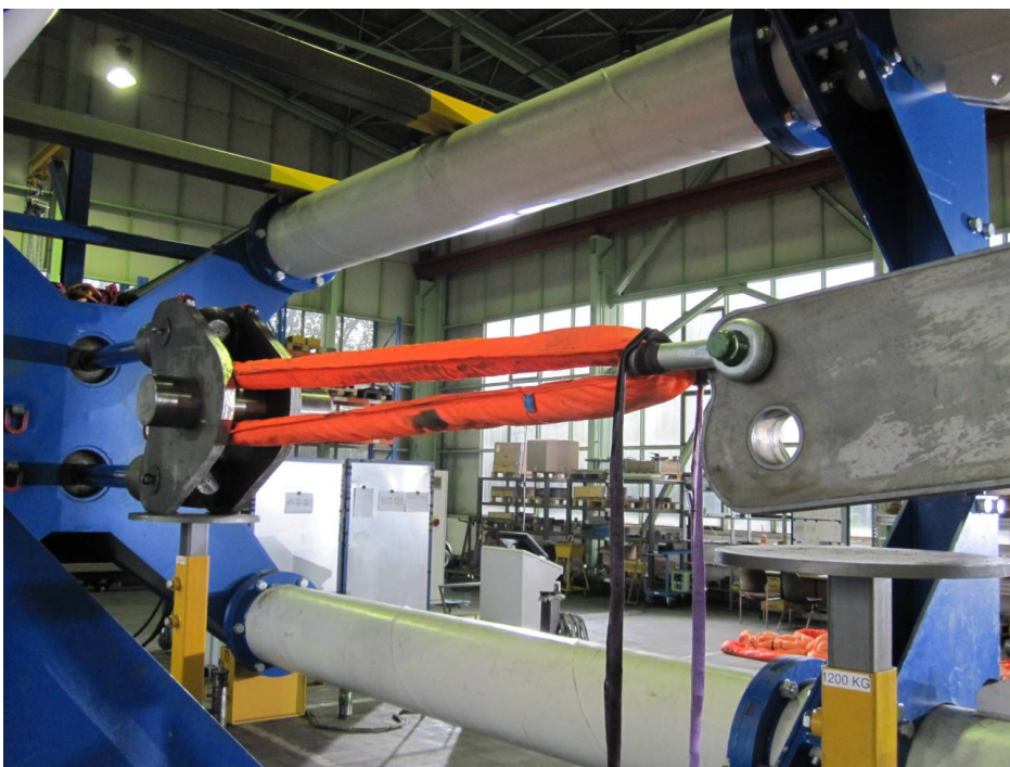
Abb. 2: Festigkeitsprüfung einer Kombination aus einem ExoSet-Schäkel mit 42,5 t Tragfähigkeit und einer 40 t Magnum-X-Rundschlinge.
