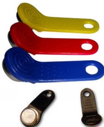
Magnetische Fahrerschlüssel iButton
