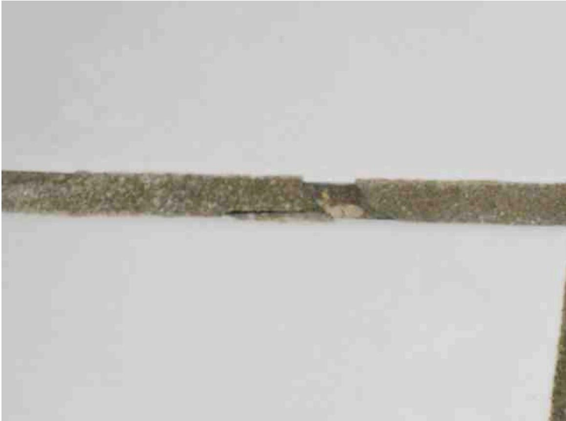
Desinfizierende Reinigungsmittel mindern zwar häufig die Verunreinigung der Fugen, rufen möglicherweise aber auch ein neues Problem hervor: Durchfeuchtungsschäden unterhalb der Dusche. Die TÜV-Untersuchung belegt schon nach einem Untersuchungszeitraum von 29 Tagen: „Bei Duschwanne 1 (10 x 10 cm Fliesen mit Standard-Fugenmasse) konnten im Laufe der Untersuchung kleine Risse im Fugenmaterial festgestellt werden.“
