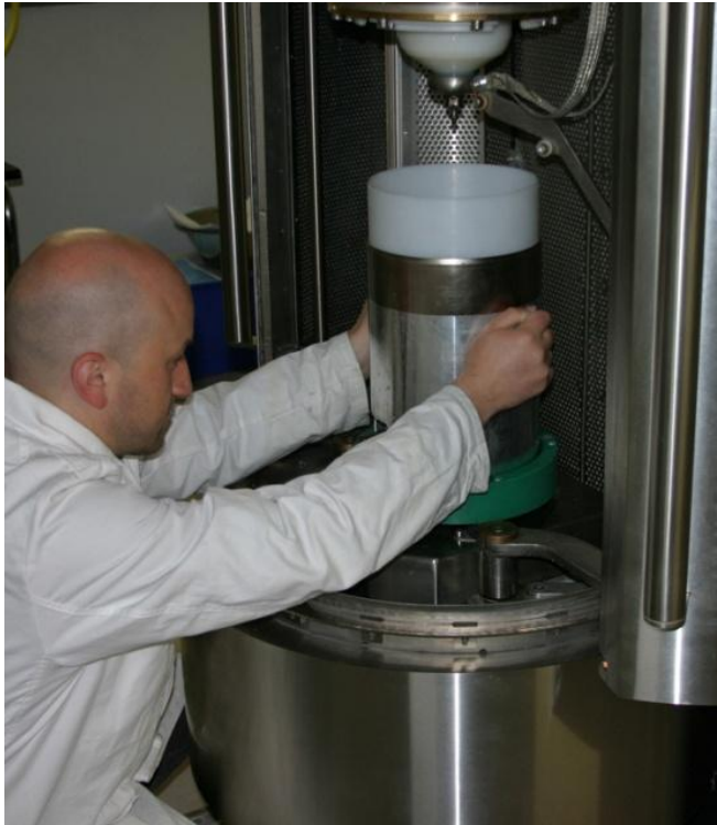
Bild 3: Für das Recycling von Karbonfaser verstärkten Kunststoffen gibt es bislang noch keine wirtschaftliche Lösung. Forscher am Fraunhofer IBP arbeiten an der Weiterentwicklung des Verfahrens der elektrodynamischen Fragmentierung. © Fraunhofer IBP
