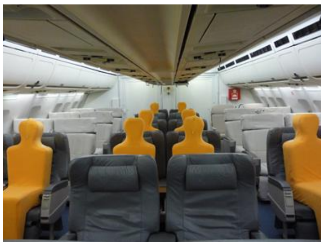
Bild 2: Testflug für neue Technologien: Die Entwicklungen des „iSpace“-Konsortiums für mehr Komfort durch individuelles Klima am Sitzplatz wurden im Fluglabor des Fraunhofer IBP untersucht. © Fraunhofer IBP
