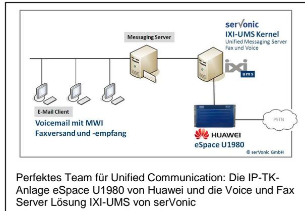
Perfektes Team für Unified Communication: Die IP-TK-Anlage eSpace U1980 von Huawei und die Voice und Fax Server Lösung IXI-UMS von serVonic
