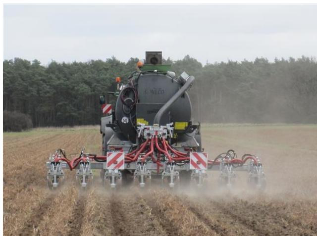
Bild 3: Streifenbild nach Bearbeitung des Bodens mit XTill-Maschinen.
