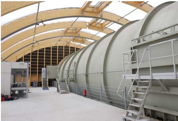
**Bild 1:** Niederdruckkammer des Fraunhofer-Instituts für Bauphysik zur Untersuchung des Raumklimas in Flugzeugen.
