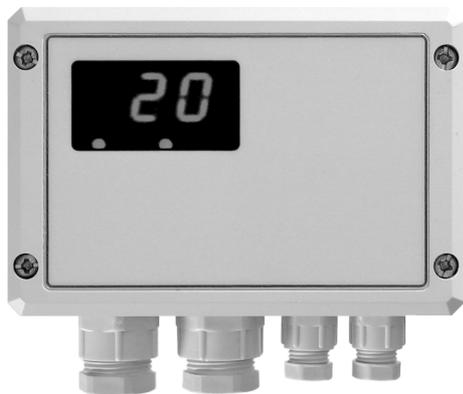
Zur bedarfsgerechten Steuerung der Ventilatoren setzen Sie unsere Warmluftrückführungs-Regelung ein. Das Gerät erfasst mit zwei Fühlern die Temperatur in Decken- und Bodennähe um nach der Temperaturdifferenz die nachgeschalteten Drehzahlregler und Ventilatoren ein und aus zu schalten.
