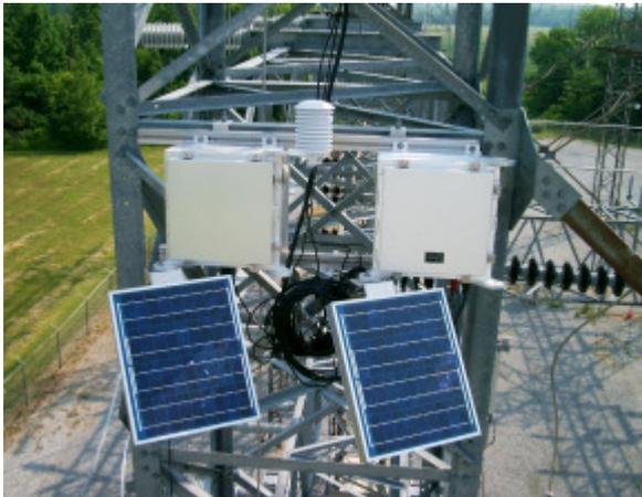
CAT-1 erfasst mit solarbetriebenen und akkugepufferten Messgeräten die mechanische Leiter-spannung, Umgebungs- und Solartemperatur und optional Winddaten.
