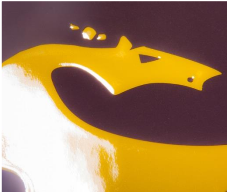
Partielle, digitale UV-Lackierung: Klarlack auf einer Soft-Touch- Folie mit spürbarem Relief und hoher Farbintensität
